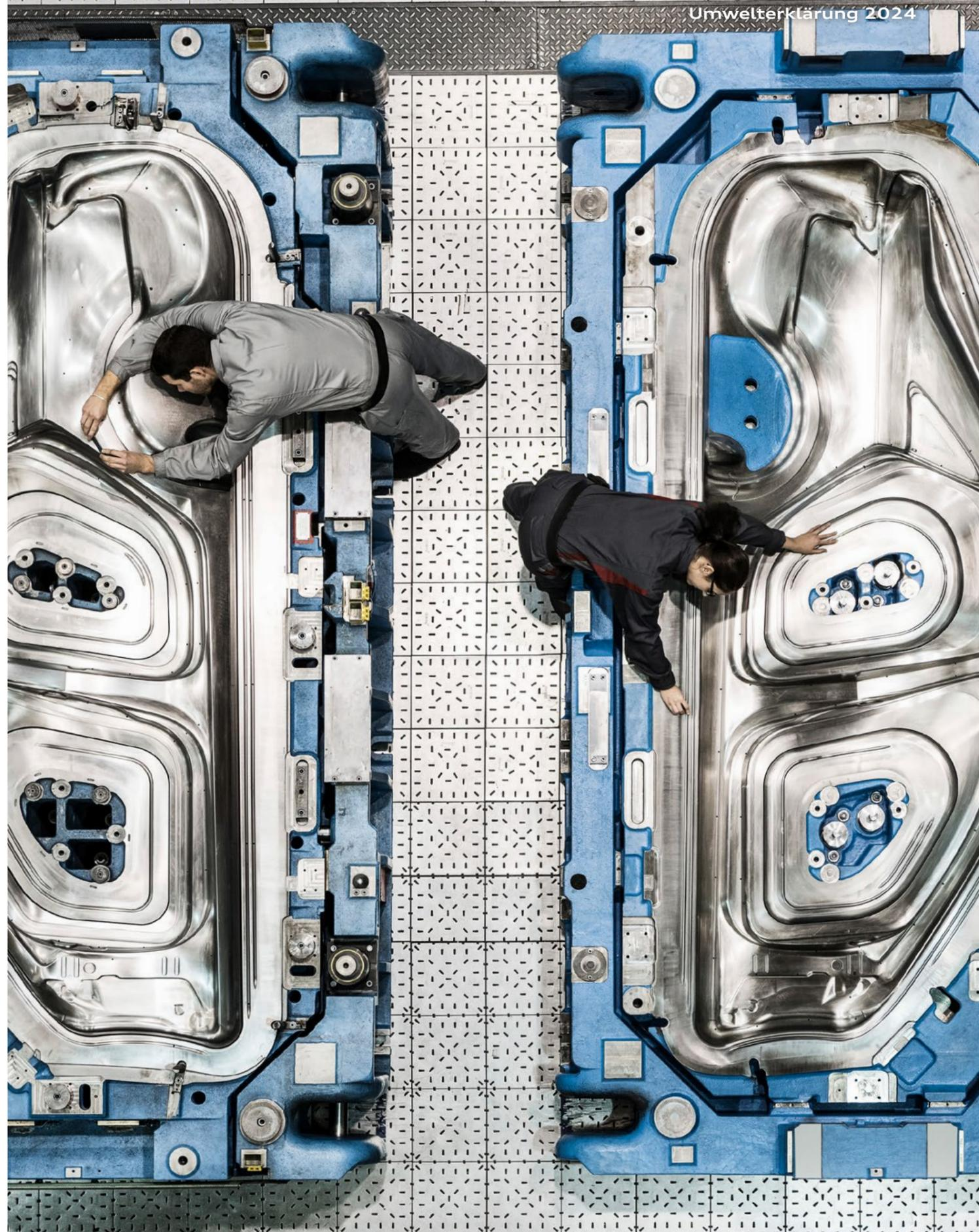
Presswerk – Aufgeklapptes Werkzeug für Seitenwandrahmen.
