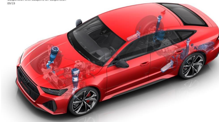
Audi RS 7 Sportback Fahrwerk mit adaptive air suspension Suspension with adaptive air suspension 09/19
