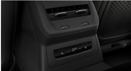
Elektronisch geregelte 3-Zonen-Komfortklimaautomatik für individuell auf Fahrer- und Beifahrerseite sowie den hinteren Fahrzeuginnenraum abgestimmte Klimatisierung. Die gewünschte Temperatur und Luftverteilung kann für jeden der drei Bereiche separat eingestellt werden.
